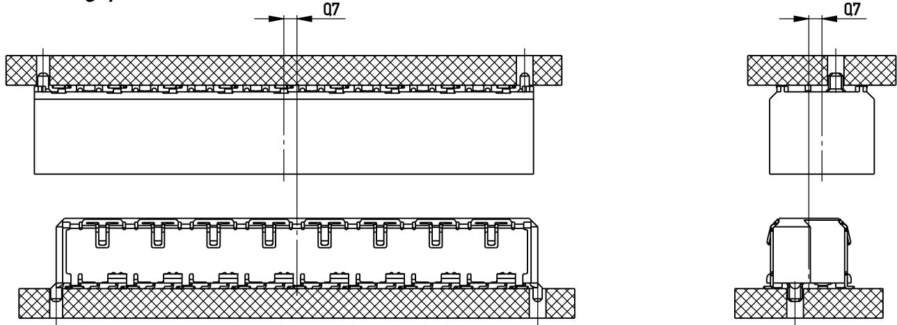
**zulässiger Winkelversatz während des Steckvorgangs, längs:  $\pm 2^\circ$ , quer:  $\pm 2^\circ$**
